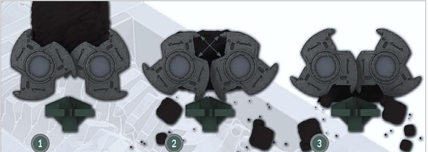
1. Противостоящие зубья роторов своими передними поверхностями захватывают материал, который затем подвергается сжатию за счет направленной деформации, создаваемой зубьями. Сжатие приводит к разрушению материала на уровне его внутренней структуры.
