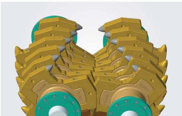
Используемый в конструкции принцип чередования зубчатых роторов создает условия, при которых сыпучий неполномерный материал проходит через постоянно изменяющиеся зазоры, создаваемые относительно медленно движущимися валами.
