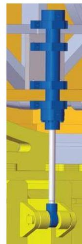
Дробящая плита с гидравлической регулировкой
