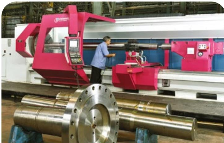
Токарный станок ЧПУ для обработки крупногабаритных изделий
