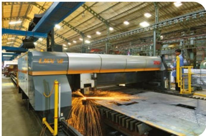
Станок лазерной резки
